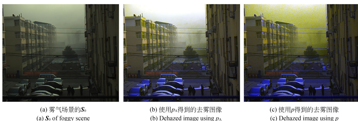
图 4 使用不同偏振度的去雾效果对比
